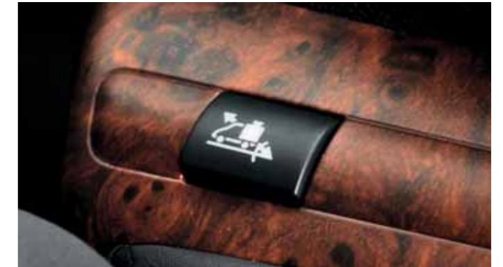
De versies met ComfortMatic-versnellingsbak hebben een speciale toets op het dashboard voor het inschakelen van de Up-functie.
