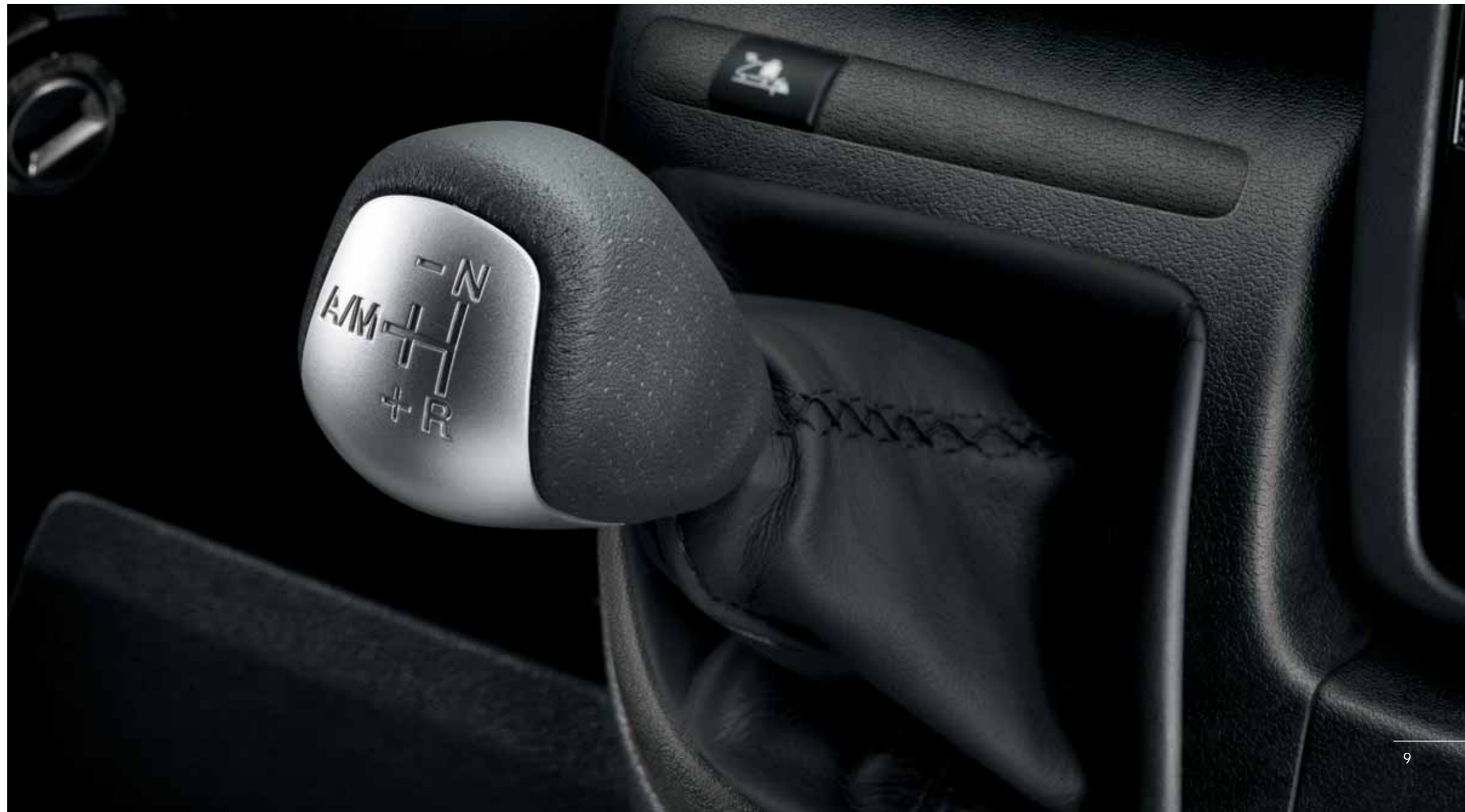
De geautomatiseerde ComfortMatic-versnellingsbak kan ook handmatig worden bediend met de korte versnellingspook in de middenconsole.
