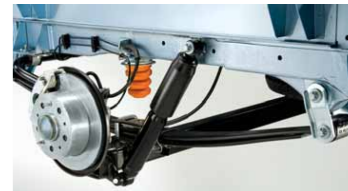
Voor heavy duty-toepassingen is op aanvraag een verzwaarde achtervering met tweebleds paraboolveren leverbaar.
