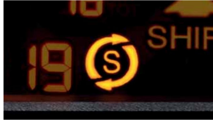
Een controlelampje op het instrumentenpaneel geeft aan wanneer het Start&Stop-systeem is ingeschakeld.
